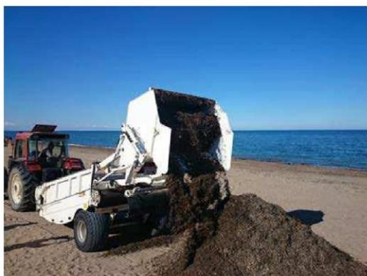
La machine SCARBAT 1.9 conçue par la société BEACH TROTTERS est polyvalente. Elle est adaptée au nettoyage des algues sargasses avec criblage et laisse sur place 90% de sable. Elle a une grande contenance de charge et peut être facilement manipulée.
